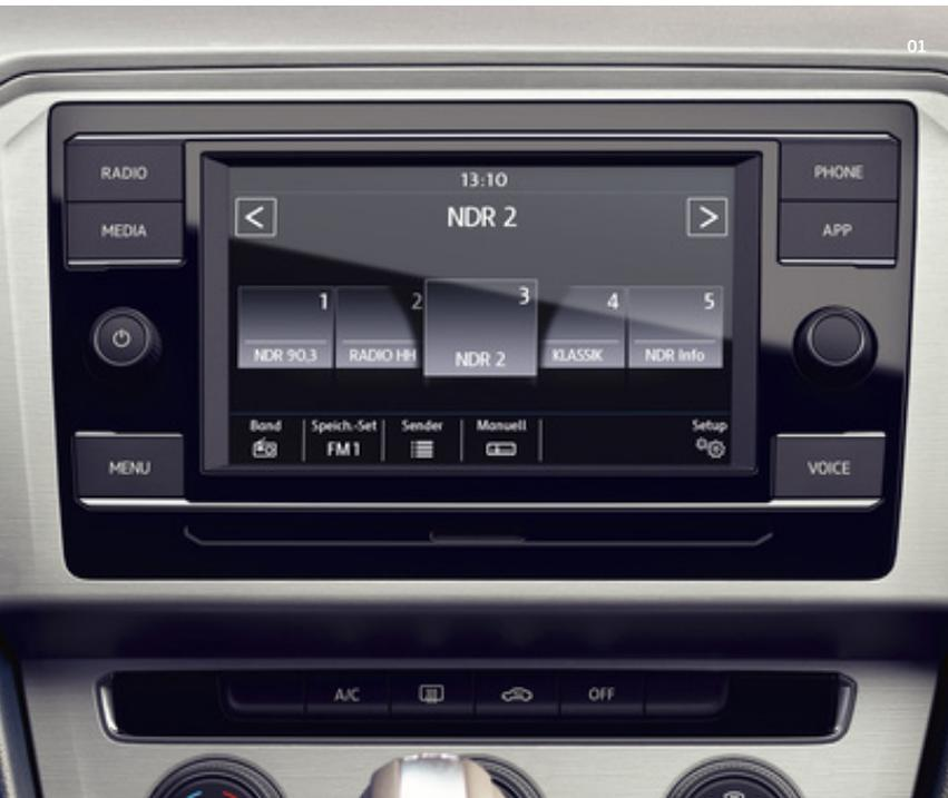
**01** La radio "Composition" está equipada con una pantalla TFT a color de 16,5 cm (6,5 pulgadas) con We Connect de serie, pantalla táctil, 4 x 20 vatios de potencia y hasta ocho altavoces. También incorpora dos interfaces USB (tipo C) e interfaz para teléfono móvil vía Bluetooth. **S**
